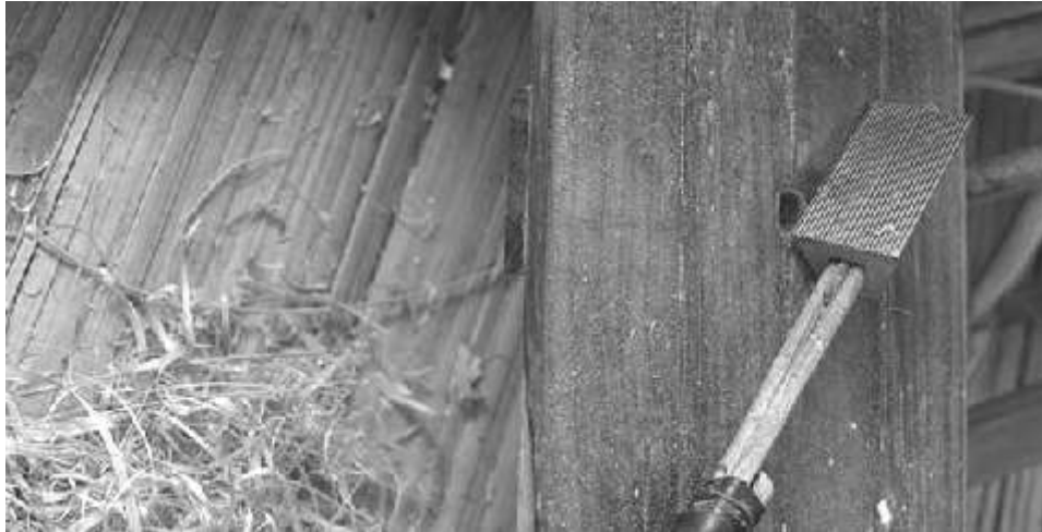
Gambar 5. Alat pemukul yang digunakan untuk membuat kertas Daluang yang terbuat dari kuningan. ( www.greenermagz.com )
