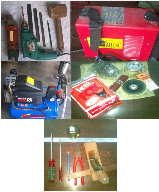
Gambar 2. Alat yang di gunakan: mesin gerinda, mesin bor, pahat, palu, kayu, mesin las listrik, mesin kompresor dan speed, lem fox, lem aibon, lem G, paku, amplas, dremel, pencil, catut, mistar besi, alat ukur dan ketam manual.
