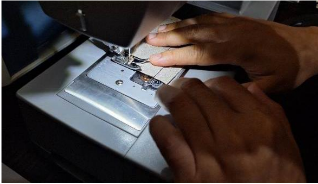
Gambar 8. Proses penjahitan pola wallet card bio-leather ampas sugu (Sumber: Dokumentasi Putri Prabu Utami)
