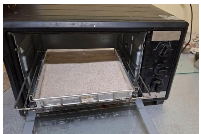
Gambar 6. Proses pengeringan komposit ampas sagu dengan oven (Sumber: Dokumentasi Putri Prabu Utami)
