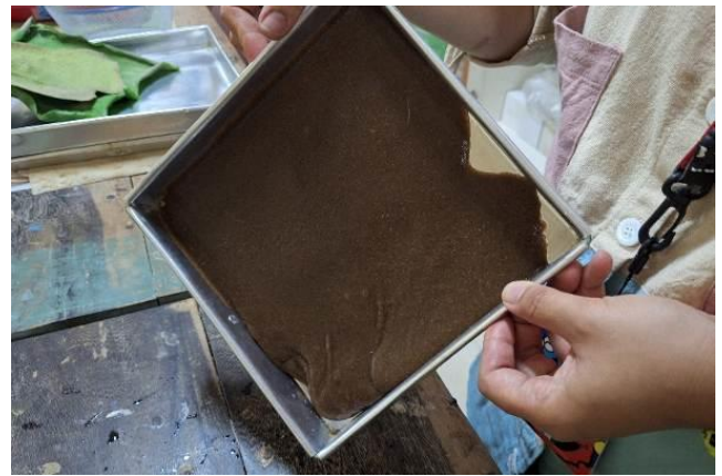
Gambar 5. Proses pencetakan komposit ampas sagu dengan baking dish (Sumber: Dokumentasi Putri Prabu Utami)
