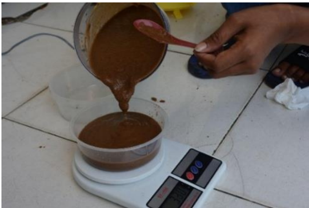
Gambar 3. Proses pencampuran ( blending ) bahan kimia pada sampel ampas sagu kering (Sumber: Dokumentasi Putri Prabu Utami)
