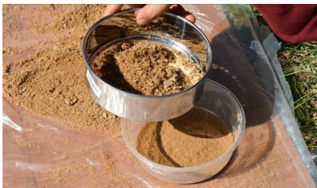
Gambar 2. Proses filtrasi (penyaringan) limbah ampas sagu kering (Sumber: Dokumentasi Putri Prabu Utami)
