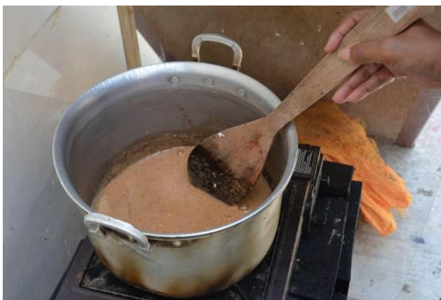
Gambar 4. Proses pelarutan dan pemanasan sampel ampas sagu dengan air (katalis) (Sumber: Dokumentasi Putri Prabu Utami)
