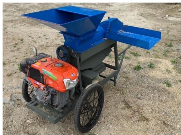
Gambar 4. Produk akhir alat pengupas kulit dan pemipil jagung
