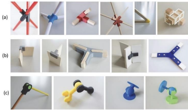
Gambar 2. Beberapa contoh fitting pencetakan 3D yang telah dikembangkan: (a) sambungan modul datar, (b) sambungan modul linear, (c) dan sambungan bergerak (Siani, 2023)
