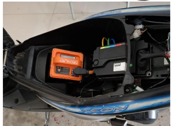
Gambar 1. Yamaha Mio Xeon GT 125 (atas). Sistem konfigurasi baterai pada product existing (bawah)
