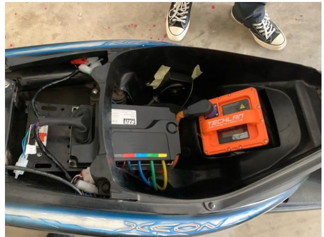
Gambar 5. Sistem konfigurasi baterai pada product existing
