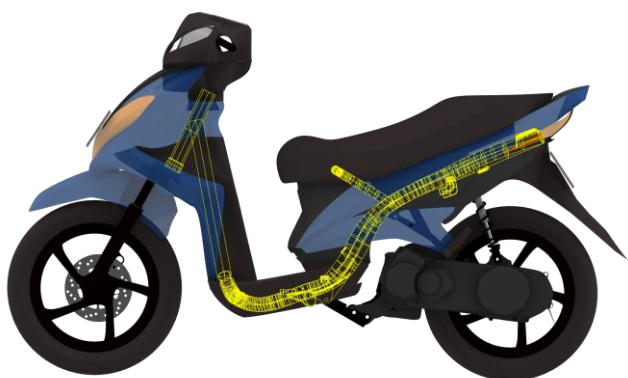
Gambar 3. Rangka sepeda motor Yamaha Xeon GT 125
