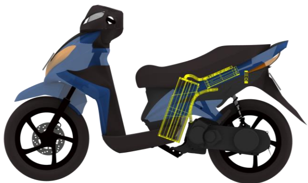
Gambar 4. Tata letak komponen sistem konfigurasi baterai
