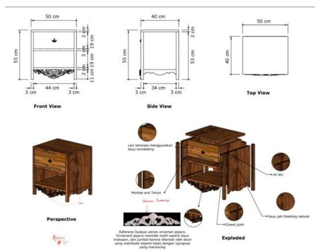
Gambar 2. Gambar kerja (Sumber: Dokumentasi penulis)
