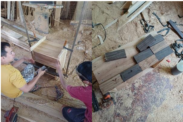
Gambar 4. Proses perakitan dan laminasi (Sumber: Dokumentasi penulis)
