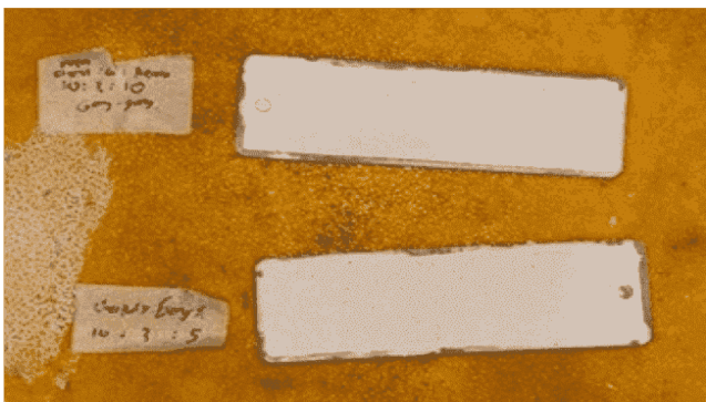
Gambar 7. Eksperimen dengan eco-resin dan kerang (Sumber: Dokumentasi Penulis)
