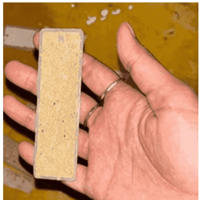
Gambar 4. Eksperimen dengan kerang: chitosan : cuka: eco-resin : air: epoxy (Sumber: Dokumentasi Penulis)
