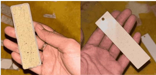
Gambar 5. Eksperimen dengan eco-resin: epoxy: kerang (Sumber: Dokumentasi Penulis)
