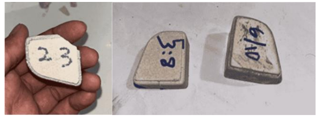
Gambar 9. Eksperimen dengan eco-resin:kerang (Sumber: Dokumentasi Penulis)
