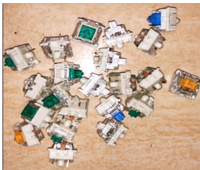
Gambar 4. Kombinasi beberapa switch keyboard modular MEYKE A.01 (Sumber: Dokumentasi Penulis)
