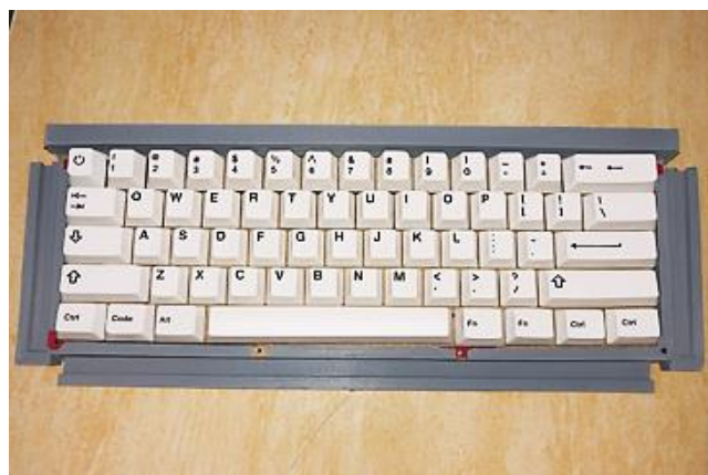
Gambar 3. Prototipe pertama keyboard modular MEYKE A.01 (Sumber: Dokumentasi Penulis)
