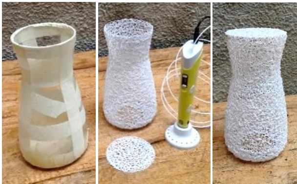
Gambar 11. Membuat grid menggunakan seal tape (kiri). Bagian carafe (tengah). Hasil pencetakan carafe (kanan).
