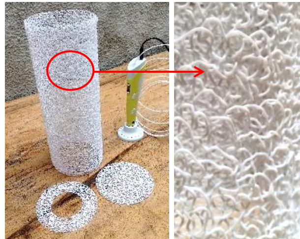
Gambar 9. Hasil mencetak setiap bagian kap lampu (kiri). Detail motif filamen (kanan).
