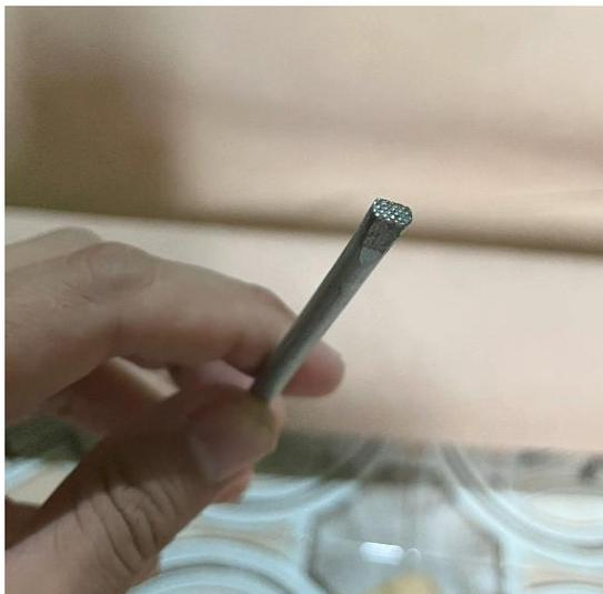
Gambar 10. Bentuk Tатаh Backgrounder/Pasir
