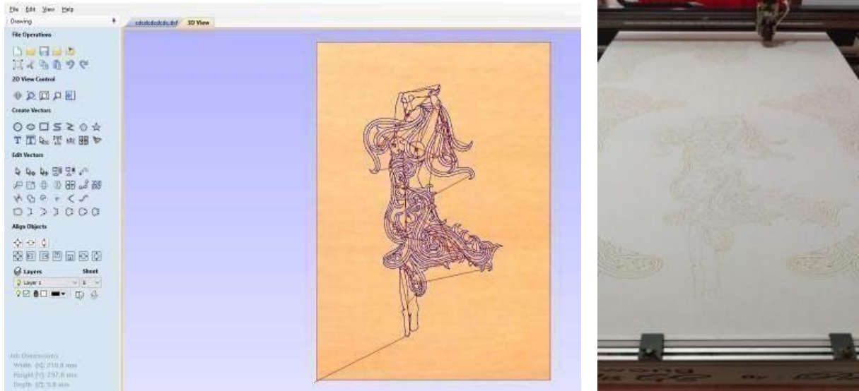
Gambar 4. Proses klowong dengan mesin klowong batik Sumber: Dokumentasi Paras Ayu
