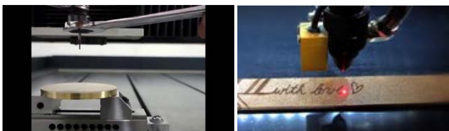
Gambar 6. Contoh proses mesin grafir laser
