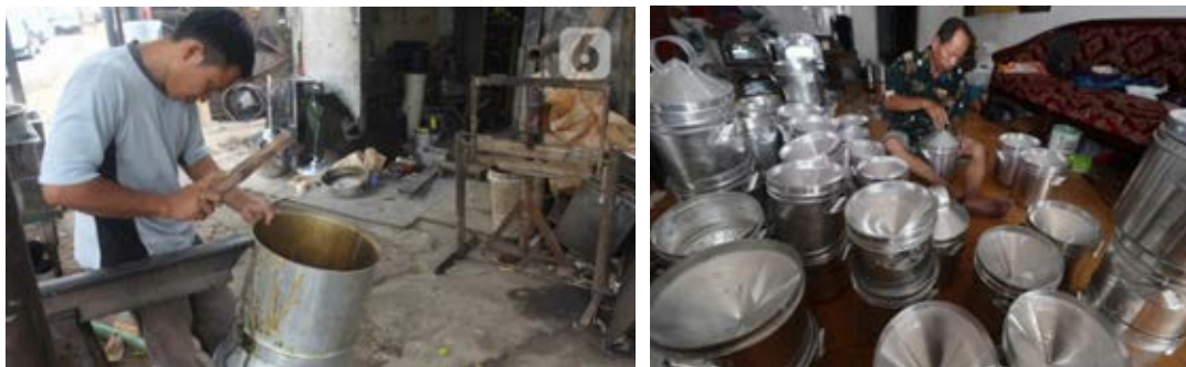
Gambar 4. Pengerjaan stainless steel dengan teknik ondel
