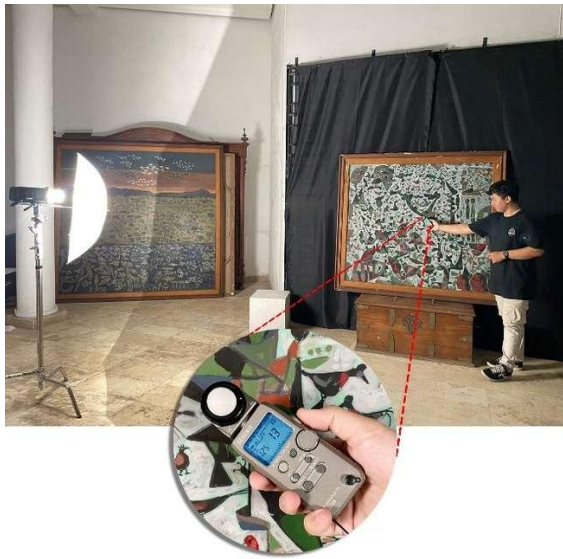
Foto 4. Proses menghitung cahaya menggunakan flash meter
